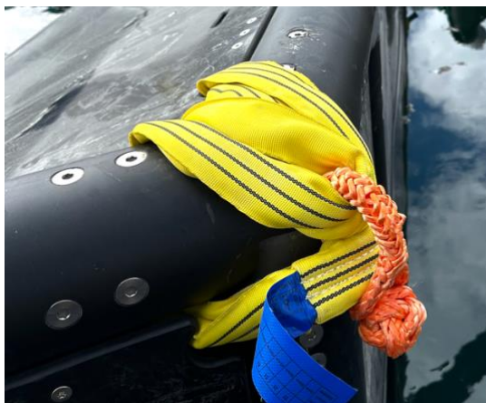
1,5 m 3T rundslyng montert på dokking
