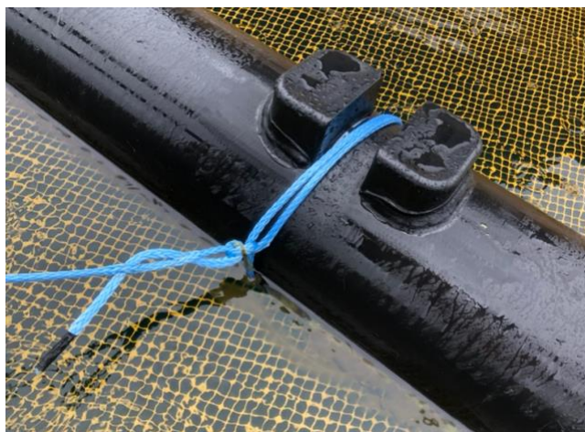
Innfesting av dynema håndvinsj tau – dobbel halstikk med låseknode og to innstikk
