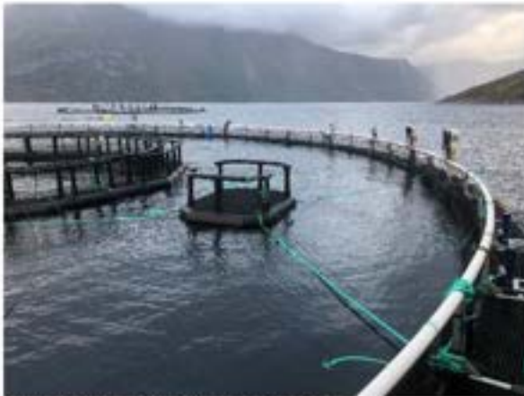
Figur 9. Arbeidsplattform innspent i permanente fortøyninger m. vinsj montert
