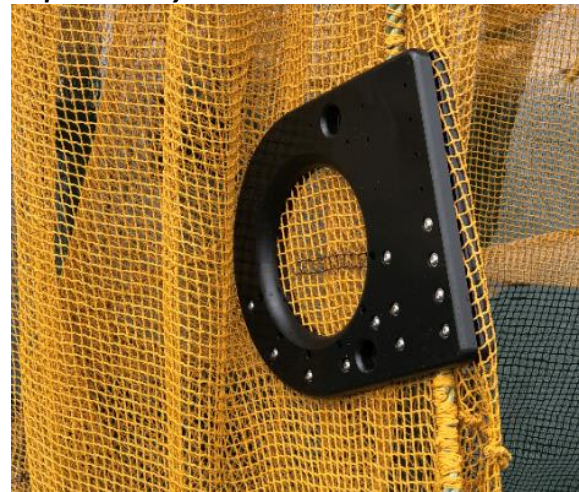
Figur 6. PE gjennomføring for LiftUp spiralslange
