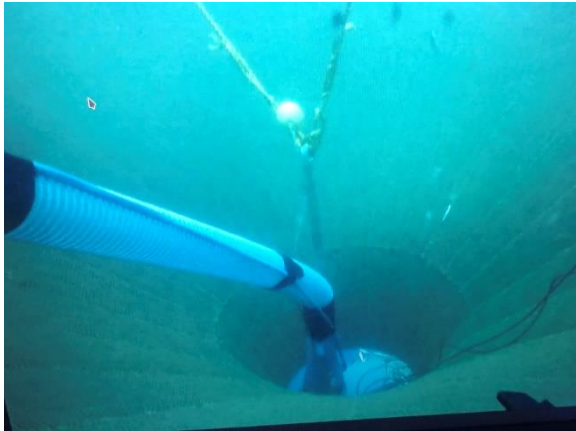
Figur 7. Drone bilde av korrekt LiftUp plassering i notspiss
